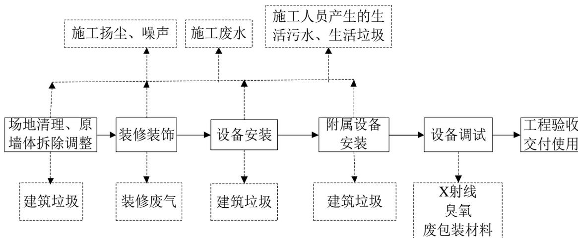
图 9-1 施工期工艺流程及产污环节示意图
