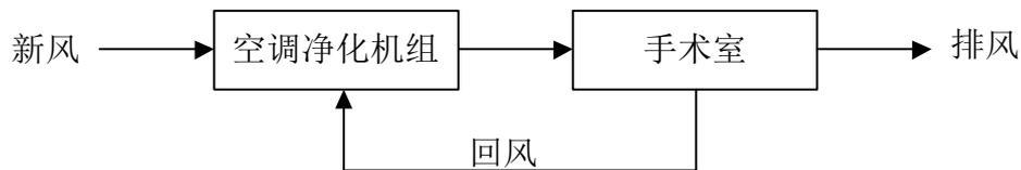
图10-5 介入治疗机房空调净化系统示意图
